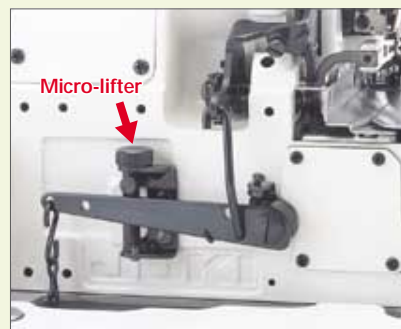
Meccanismo di microregolazione del trasporto dif. inferiore e superiore
